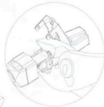
⑥ Steckerabdeckung schließen und sicherstellen, dass der beidraht einen guten Kontakt zum Gehäuse hat.
