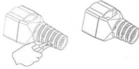
③ Kabeladämm aufdrehen und entsprechend Farbcode im Kabelmanager positionieren. Kabelenden kürzen.
