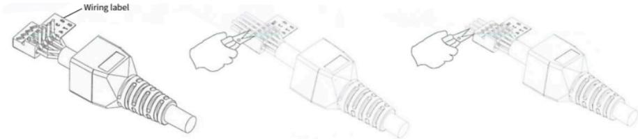
④ Place wiring cap on plug.
